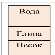
Рис. 2. Схема распределения фракций при отмучивании глины в реакторе
